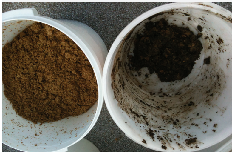
Slika 3 – Bioplinska produkcije iz pivskih tropin v dvostopenjski fazno ločeni anaerobni digestiji (povzeto po Panjičko in sod., 2016) in slika tropin pred in po digestiji
